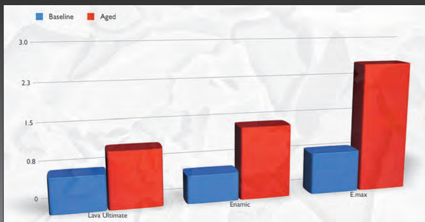
Рис. 9. Шероховатость эмали антагониста при контакте с реставрацией из полимера, усиленного керамикой (Lava Ultimate, Vita Enamic), и с реставрацией из керамики на основе дисиликата лития (IPS e.max CAD) до и после циклического теста
